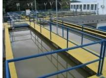
Pré-sedimentação e coagulação: ocorre a sedimentação das partículas maiores e a adição de coagulante, que irá unir as impurezas.
